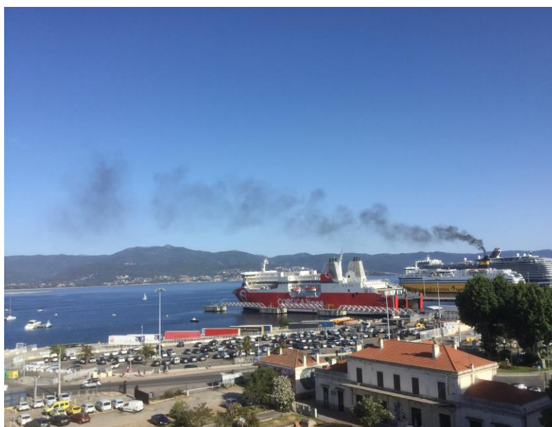
Figure 8 : Panache d'un navire sur Ajaccio suivant la composante de vent principale Nord / Sud
